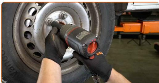
**35** Χαμηλώστε το αυτοκίνητο και χρησιμοποιήστε σταυρό, προκειμένου να σφίξετε τα μπουλόνια των τροχών. Χρησιμοποιήστε κρουστικό καρυδάκι για μπουλονόκλειδο Νο #19. Χρησιμοποιήστε ένα δυναμόκλειδο. Σφίξτε τη με ροπή 180 Nm.
