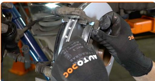
**29** Τοποθετήστε τη δαγκάνα του φρένου και σφίξτε τη. Χρησιμοποιήστε ένα καρυδάκι #22. Χρησιμοποιήστε ένα δυναμόκλειδο. Σφίξτε τη με ροπή 35 Nm.
