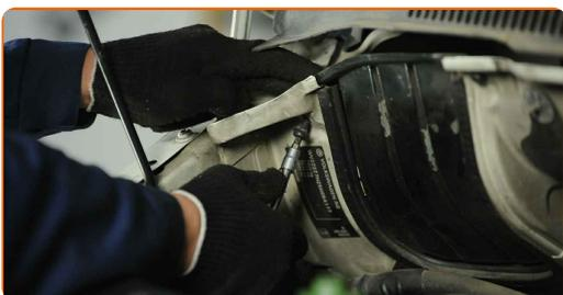
**67** Τοποθετήστε την τσιμούχα του τροπέτου των υαλοκαθαριστήρων.
