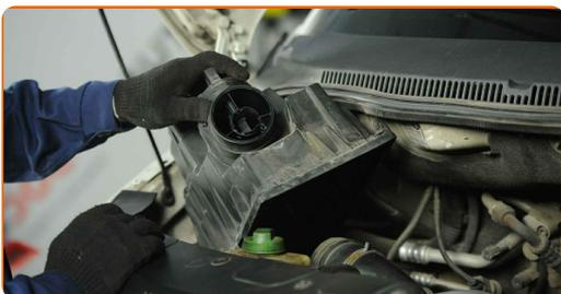
**70** Συνδέστε τον σωλήνα εισαγωγής αέρα στο περίβλημα του φίλτρου λαδιού.
