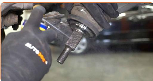
**82** Τοποθετήστε το ακραξόνιο στον άξονα μετάδοσης κίνησης.
