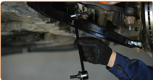
**12** Σφίξτε το στοιχείο στερέωσης που συνδέει το μπαράκι της αντιστρεπτικής στην αντιστρεπτική δοκό. Χρησιμοποιήστε ένα γερμανοπολύγωνο #19. Χρησιμοποιήστε ένα Άλεν No.H5. Χρησιμοποιήστε ένα δυναμόκλειδο. Σφίξτε τη με ροπή 60 Nm.+45°
