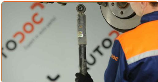
**13** Καθαρίστε τις βάσεις τοποθέτησης του αμορτισέρ. Χρησιμοποιήστε μια συρματόβουρτσα. Χρησιμοποιήστε σπρέι WD-40.
