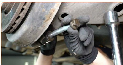
**10** Ξεβιδώστε το επάνω παξιμάδι του αμορτισέρ. Χρησιμοποιήστε ένα καρυδάκι #18. Χρησιμοποιήστε μια κασάνια.
