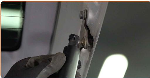
**8** Κουμπώστε το κλιπ ασφάλισης που συνδέει το αμορτισέρ αερίου με το αμάξωμα του αυτοκινήτου. Χρησιμοποιήστε ένα ίσιο κατσαβίδι.
