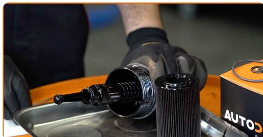
**14** Αφαιρέστε τα παλιά Ο-ρινγκ από το κάλυμμα του φίλτρου. Χρησιμοποιήστε ένα ίσιο κατσαβίδι.
