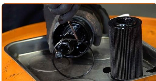
**15** Καθαρίστε το καπάκι του περιβλήματος του φίλτρου λαδιού. Χρησιμοποιήστε ένα σπρέι καθαρισμού γενικής χρήσης.
