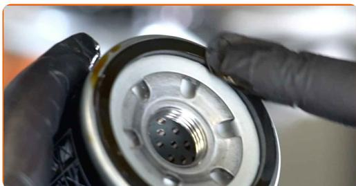
**15** Τοποθετήστε ένα καινούριο φίλτρο λαδιού.
