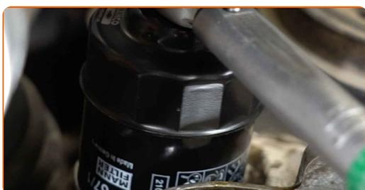
**17** Καθαρίστε το φίλτρο λαδιού. Χρησιμοποιήστε ένα σπρέι καθαρισμού γενικής χρήσης.
