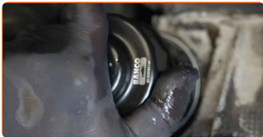
**16** Σφίξτε το φίλτρο λαδιού. Θυμηθείτε να τηρήσετε τη συνιστώμενη ροπή σύσφιξης. Χρησιμοποιήστε ένα καρυδάκι 65-14F. Χρησιμοποιήστε ένα δυναμόκλειδο. Σφίξτε τη με ροπή 24 Nm.
