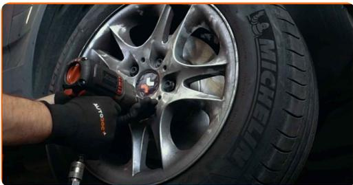
**70** Χαμηλώστε το αυτοκίνητο και χρησιμοποιήστε σταυρό, προκειμένου να σφίξετε τα μπουλόνια των τροχών. Χρησιμοποιήστε κρουστικό καρυδάκι για μπουλονόκλειδο No #17. Χρησιμοποιήστε ένα δυναμόκλειδο. Σφίξτε τη με ροπή 140 Nm.
