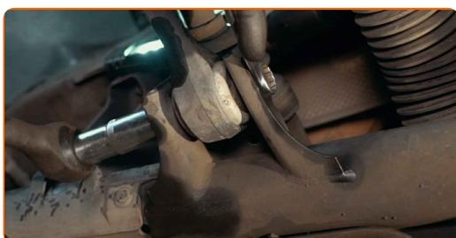
**56** Σφίξτε τα στοιχεία στερέωσης που συνδέουν τον βραχίονα ελέγχου και το υποπλαίσιο. Χρησιμοποιήστε ένα γερμανοπολύγωνο #16. Χρησιμοποιήστε ένα καρυδάκι #18. Χρησιμοποιήστε ένα δυναμόκλειδο. Σφίξτε τη με ροπή 110 Nm.
