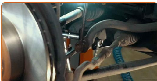
**57** Σφίξτε το κάτω στοιχείο σύσφιξης του αμορτισέρ. Χρησιμοποιήστε ένα καρυδάκι #16. Χρησιμοποιήστε ένα καρυδάκι #18. Χρησιμοποιήστε ένα δυναμόκλειδο. Σφίξτε τη με ροπή 100 Nm.
