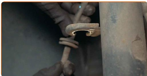
**11** Καθαρίστε τα στοιχεία στερέωσης των μπαρακιών της αντιστρεπτικής δοκού. Χρησιμοποιήστε μια συρματόβουρτσα. Χρησιμοποιήστε σπρέι WD-40.
