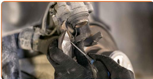
**19** Αποσυνδέστε τον αισθητήρα φθοράς των τακακιών των φρένων. Χρησιμοποιήστε ένα ίσιο κατσαβίδι.
