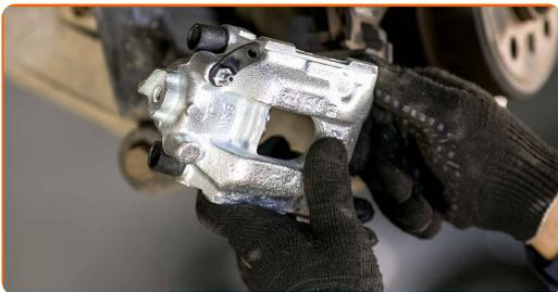
**24** Σφίξτε το στοιχείο στερέωσης που συνδέει το μαρκούτσι των φρένων στη δαγκάνα του φρένου. Χρησιμοποιήστε ένα κλειδί σωλήνων φρένων. Χρησιμοποιήστε ένα δυναμόκλειδο. Σφίξτε τη με ροπή 40 Nm.
