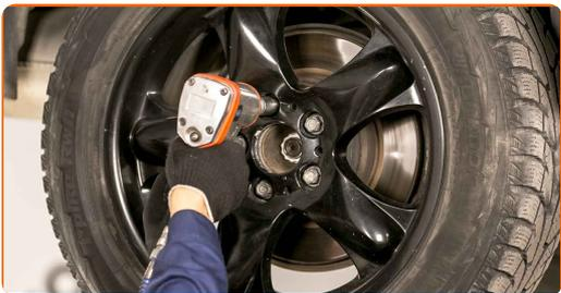
**46** Χαμηλώστε το αυτοκίνητο και χρησιμοποιήστε σταυρό, προκειμένου να σφίξετε τα μπουλόνια των τροχών. Χρησιμοποιήστε κρουστικό καρυδάκι για μπουλονόκλειδο No #17. Χρησιμοποιήστε ένα δυναμόκλειδο. Σφίξτε τη με ροπή 140 Nm.
