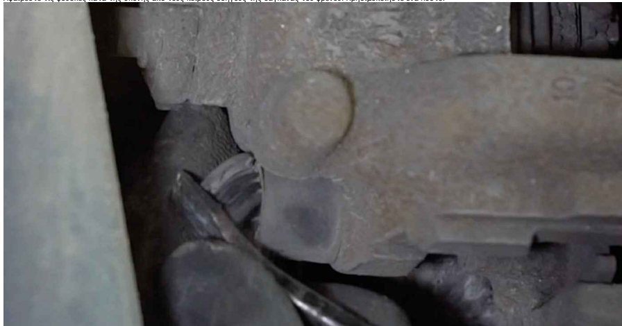
12 Ξεβιδώστε τον σφικτήρα της δαγκάνας των φρένων. Χρησιμοποιήστε ένα Άλεν No.17. Χρησιμοποιήστε μια κασάνια.
