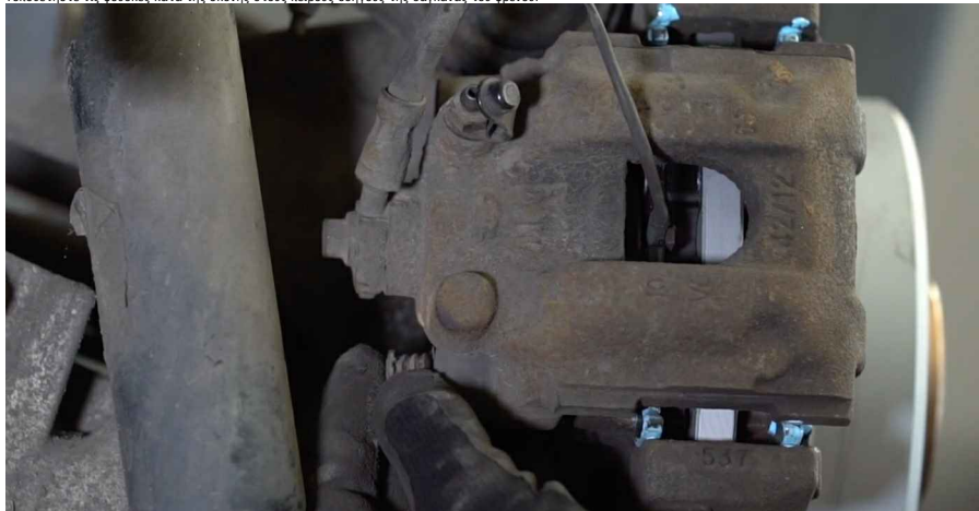
24 Τοποθετήστε την ασφάλεια στη δαγκάνα.
