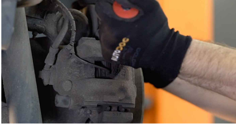
11 Αφαιρέστε τις φούσκες κατά της σκόνης από τους πείρους οδηγούς της δαγκάνας του φρένου. Χρησιμοποιήστε ένα λαστό.
