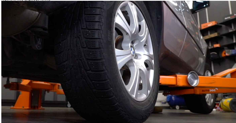
6 Ξεσφίξτε τα μπουλόνια στερέωσης του τροχού. Χρησιμοποιήστε κρουστικό καροδάκι για μπουλονόκλειδο No #19.
