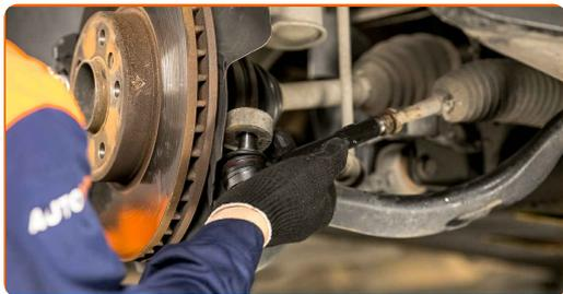
**17** Σφίξτε το παξιμάδι στερέωσης που συνδέει το μπαλάκι του ακρόμπαρου με το μουαγιέ. Χρησιμοποιήστε ένα Άλεν Νο.Η6. Χρησιμοποιήστε ένα γερμανοπολύγωνο #22. Χρησιμοποιήστε ένα δυναμόκλειδο. Σφίξτε τη με ροπή 80 Nm.
