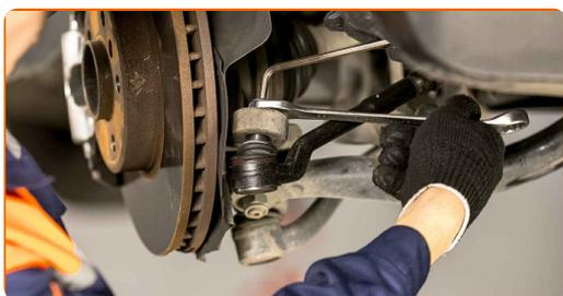
**18** Σφίξτε το παξιμάδι σύνδεσης του μπαλακιού με το ακρόμπαρο. Χρησιμοποιήστε ένα γερμανοπολύγωνο #13. Χρησιμοποιήστε ένα γερμανοπολύγωνο #24. Χρησιμοποιήστε ένα δυναμόκλειδο. Σφίξτε τη με ροπή 51 Nm.
