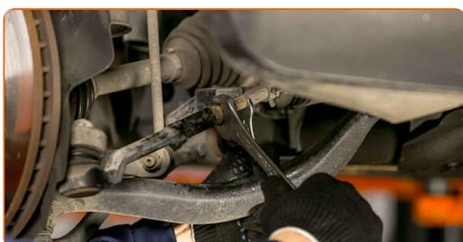
**8** Καθαρίστε το στοιχείο στερέωσης που συνδέει το μπαλάκι του ακρόμπαρου με το μουαγιέ. Χρησιμοποιήστε μια συρματόβουρτσα. Χρησιμοποιήστε σπρέι WD-40.
