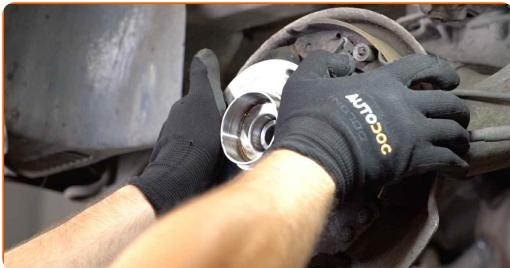
**15** Σφίξτε την πλήμνη. Χρησιμοποιήστε ένα καρυδάκι #32. Χρησιμοποιήστε ένα δυναμόκλειδο. Σφίξτε τη με ροπή 225 Nm.
