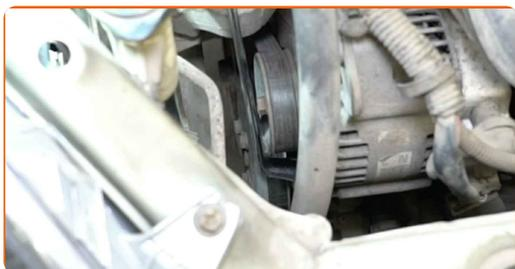
4 Χαλαρώστε το μοχλό του τεντωτήρα του ιμάντα V με ραβδώσεις. Χρησιμοποιήστε ένα γερμανοπολύγωνο #12.
