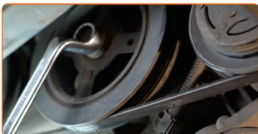
**9** Τοποθετήστε τον ιμάντα με ραβδώσεις V στο δυναμό. Χρησιμοποιήστε ένα λοστό.
