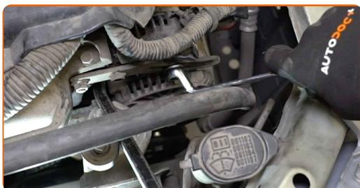
**11** Σφίξτε τα στοιχεία στερέωσης του δυναμό. Χρησιμοποιήστε ένα καρυδάκι #12. Χρησιμοποιήστε ένα δυναμόκλειδο. Σφίξτε τη με ροπή 15 Nm.
