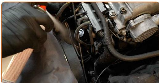
**10** Ξεβιδώστε το καπάκι του καλύμματος του φίλτρου μαζί με το παλιό στοιχείο φιλτραρίσματος. Χρησιμοποιήστε ένα καρυδάκι #36. Χρησιμοποιήστε μια καστίνα.
