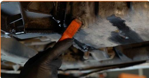
**7** Ξεβιδώστε την τάπα αποστράγγισης. Χρησιμοποιήστε ένα Τορξ T45. Χρησιμοποιήστε μια καστίνα.
